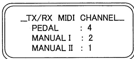
オルガンの3つの鍵盤部に対応する3つのフィールドが表示されます。横の数字がその鍵盤部の送受信チャンネルを示しています。
