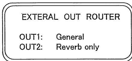
この画面には2つのオーディオ・アウトプット OUT1([OUTPUT 1])と、OUT2 ([OUTPUT 2])が表示され、各アウトプットの設定ができます。
