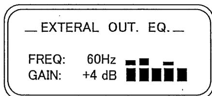
その設定画面は、内部イコライザーの画面と同じです。[FIELD ▲]、[FIELD ▼] ボタンを使ってトリガー・フリークエンシーを選び、[VALUE +] と [VALUE -] を使って、信号を $\pm 9$ dBの範囲で調整できます。
