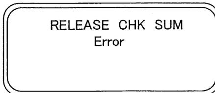
[FIELD ▲], [VALUE +], [EXIT]の3つを同時に押したまま、電源スイッチをオンにし、アップデートの手順を繰り返して下さい。
