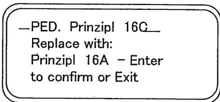
一番上に交換する前のボイスが表示され、その下に、新しく使用するボイスが表示されます。
