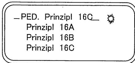
一番上には交換しようとしているボイスが表示され、その下に、そのストップで交換可能なボイスが表示されます。
